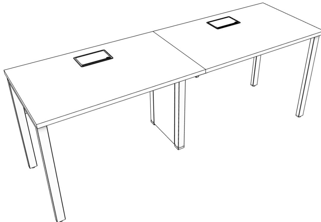
Faça a união dos tampos fixando as chapas de união presentes no kit do módulo auxiliar.
