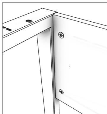
2. - Fixe a Calha berço(3) no Painel Frontal(2) com parafuso 4.8x13(C).
