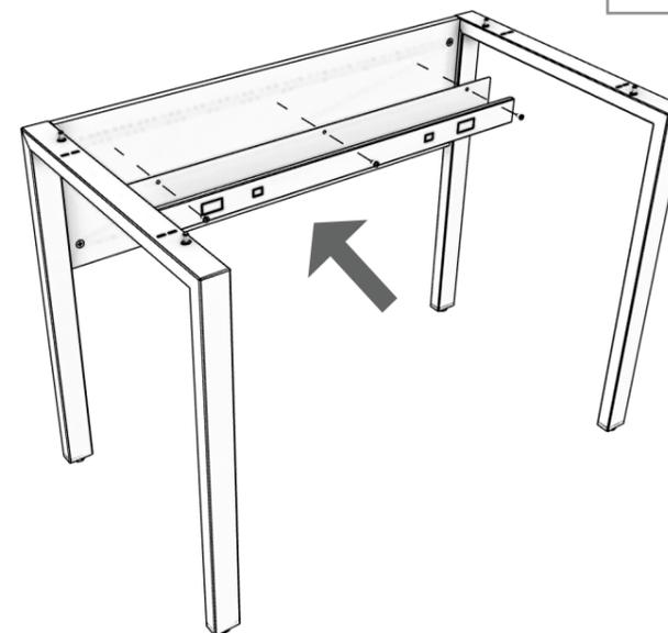
A Calha Berço pode ser posicionada e fixada livremente no painel frontal através de parafusos auto-atarraxantes
