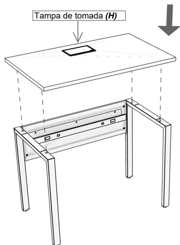
Aplique os tampos e faça a fixação na estrutura metálica.
